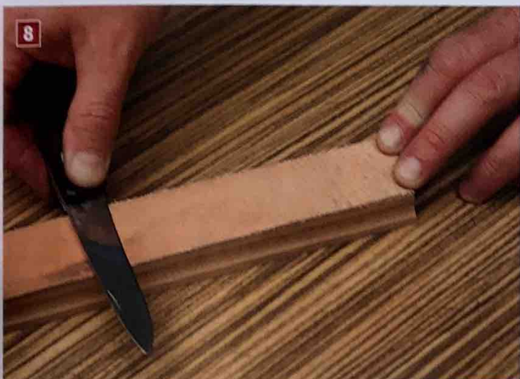
8 Beim Abziehen auf dem Leder bewegt man die Klinge stets in Richtung Klingleiten - sonst würde man ins Leder schneiden. Dabei arbeitet man im Schärftwinkel praktisch nur mit dem Eigengewicht des Messers.
