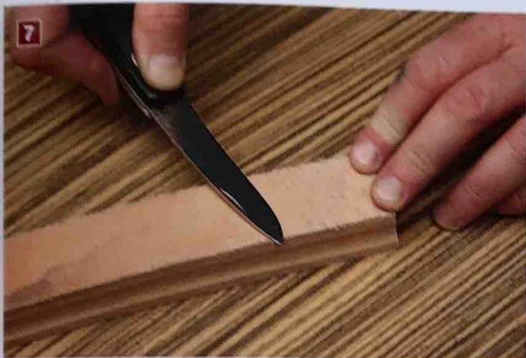
7 Nach dem feinsten Diamantschleifstein kann man auch direkt zum Abziehleder wechseln, das auf einem Buchenholzscheit befestigt ist. Die Schleif- und Pollerpaste ist im Set enthalten.
