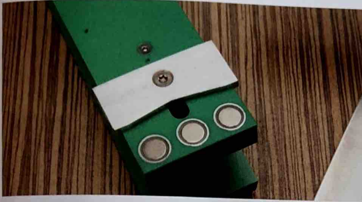
Drei starke Magnete fixieren die Klinge des aufgelegten Messers. Mit dem Rücken liegt die Klinge an einer verschiebbaren Halterung an.
