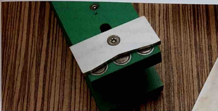
Für schmalere Klingen schiebt man den Anschlag ganz nach vorne. Die Haltekraft der Magnete ist trotz teilweiser Abdeckung hoch genug.
