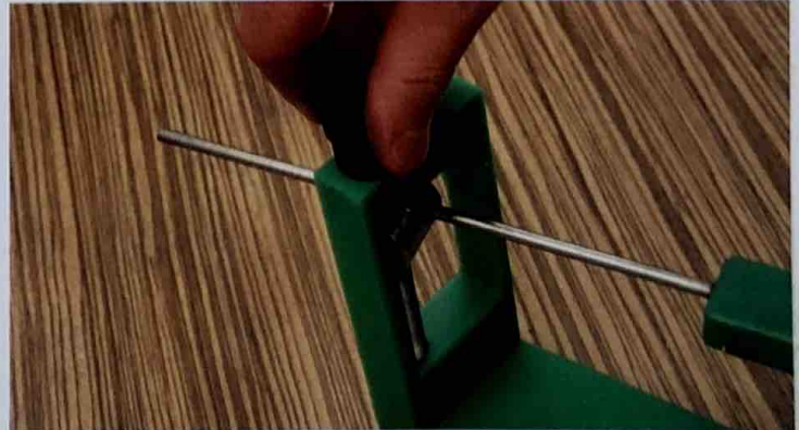
Auf der oben und unten gelagerten Spindel sitzt die Halterung für die Führungsstange der Schleifsteinhalterung.
