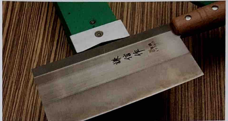
Ist die Halterung komplett zurückgeschoben, lassen sich sogar extrem breite Klingen schärfen.
