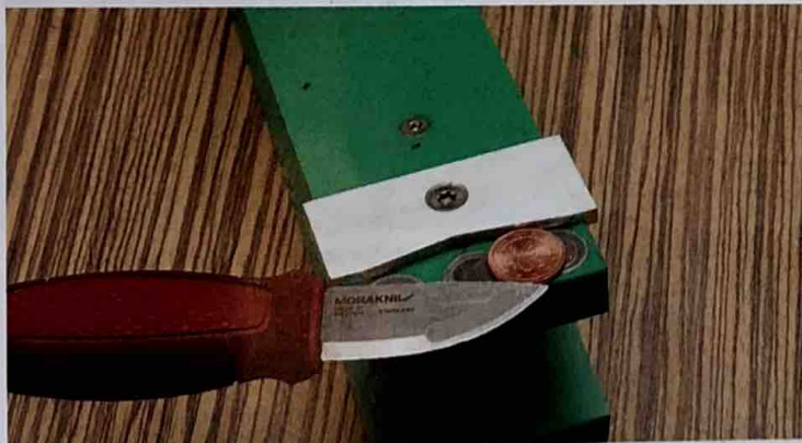
Bei besonders kurzen oder ungewöhnlich geformten Klingen muss man etwas tricksen. Hier übernimmt ein 5-Cent-Stück den Klingensschlag.
