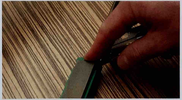
Die Schleifsteine sind auf Metallträgern befestigt. Ein Magnet auf dem Schleifsteinhalter fixiert die Steine sicher.
